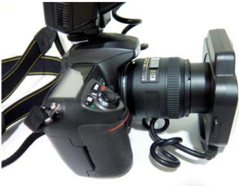
Figura 2. Cámara fotográfica digital Nikon D 200 con el lente macro y flash de anillo.
